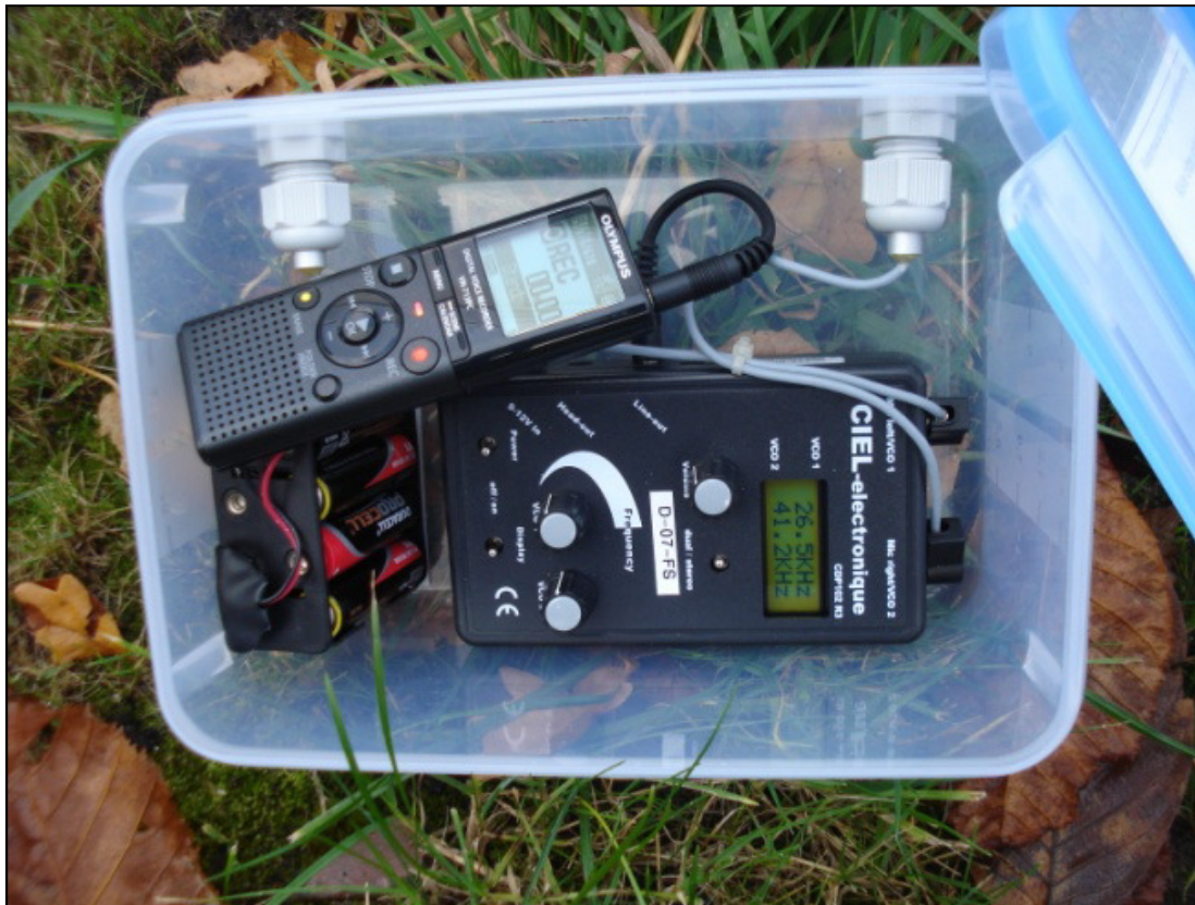
Abb. 1: Schematischer Aufbau einer Horchkiste
